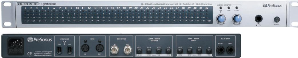
32개 입력의 레코딩이 필요하다면 ADAT lightpipe을 통한 FireStudio Lightpipe를 연결하여 레코딩을 라이브 공연에 더할 수 있다. PreSonus FireStudio Lightpipe은 32입력, 32출력, 24bit/96k lightpipe의 프로급 디지털 오디오 레코딩에 적합한 Firewire 컴퓨터 레코딩 시스템이다. 윈도우, 매킨토시 컴퓨터와 모두 호환되며, Firewire를 통해 ADAT 또는 SMUX 옵티컬 lightpipe 입출력의 32채널을 컨버팅할 수 있게 한다.
