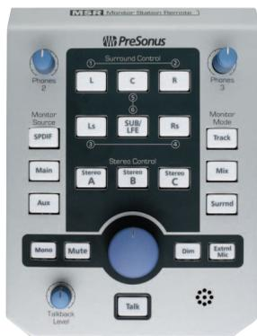
Monitor Station Remote (MSR)은 서라운드 사운드/스테레오 스피커 매니저, 입력 변경, 음악 제작에 효율적이고 빠른 처리를 위한 커뮤니케이션 기능을 모두 갖춘 통합 시스템이다. MSR은 FireStudio와 표준 이더넷 케이블로 연결되며 사용자의 편의를 위해 2개의 헤드폰 출력이 추가된다. MSR은 FireStudio의 컨트롤 콘솔 소프트웨어와의 연동으로 상응하는 버튼을 누름으로써 믹스 트랙 라우팅, 입/출력 변경 및 토크백과 같은 기능들을 제어할 수 있다. MSR은 현존하는 어떠한 레코딩 시스템과 비교할 수 없는 합리적인 가격에 새로운 레벨의 완벽한 스튜디오 컨트롤을 제공한다. FireStudio와 MSR은 음악 제작 환경에 있어 창조적인 업무 흐름을 강화할 수 있게 제작된 통합 레코딩 솔루션이다.
