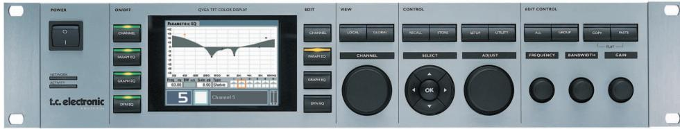
EQ Station은 TC Electronic의 최첨단 48 bit DSP와 최상의 ADA 변환 기술이 적용된 최고의 디지털 EQ 시스템으로 작동의 편리함과 뛰어난 성능을 하나의 기기로 구현한 제품이다. 또한 사용자 인터페이스나 제품 레이아웃 등의 주요 제어 기능은 라이브 사운드 조건에 최적으로 설계되었다. MotoFader 64 리모트 컨트롤을 통해 실시간으로 이퀄라이징을 할 수 있으며, Virtual EQ Station을 통해 PC를 통한 제품의 제어도 가능하다.
